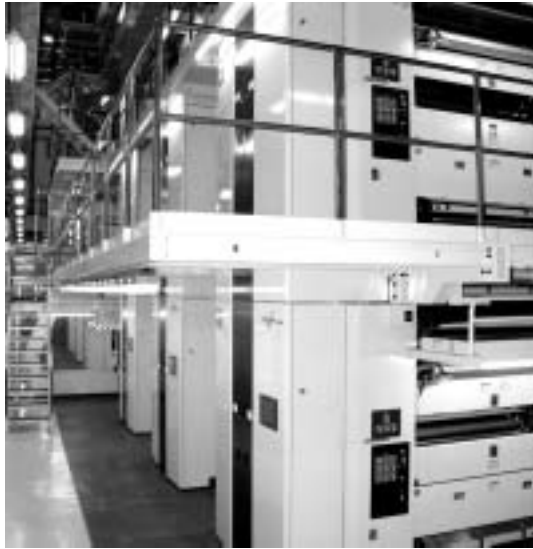
カラートップエコプリウス (7100 U D H) オフセット 輪転機
